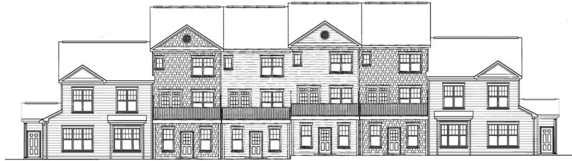
6 UNIT - REAR ELEVATION SCALE: 1/8" = 1'-0"
